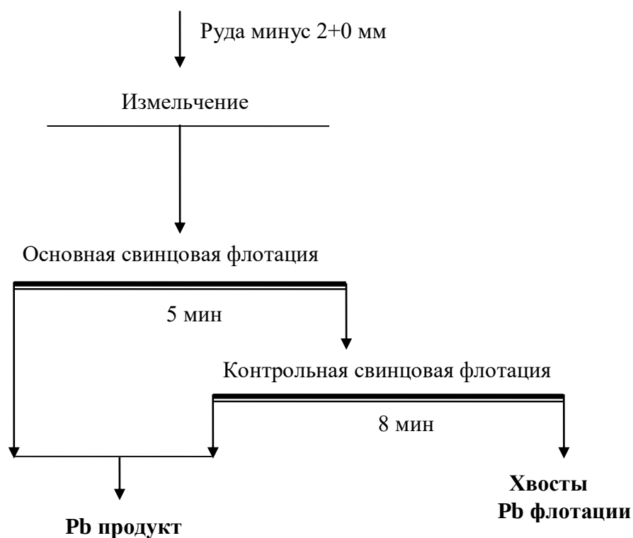
Рисунок 7 – Схема открытых опытов по подбору оптимальной степени измельчения и по подбору реагентов
